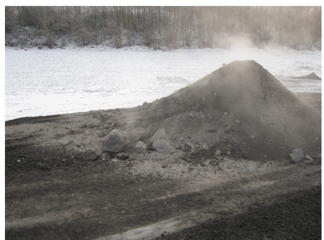
Abb. 4+5: Auf beiden Bildern ist zu sehen, wie unterschiedlich durchfeuchtet und damit staubend der abgeschüttete Filterstaub ist (feuchter Filterstaub: dunkle Farbe, trockener Filterstaub: hell).
