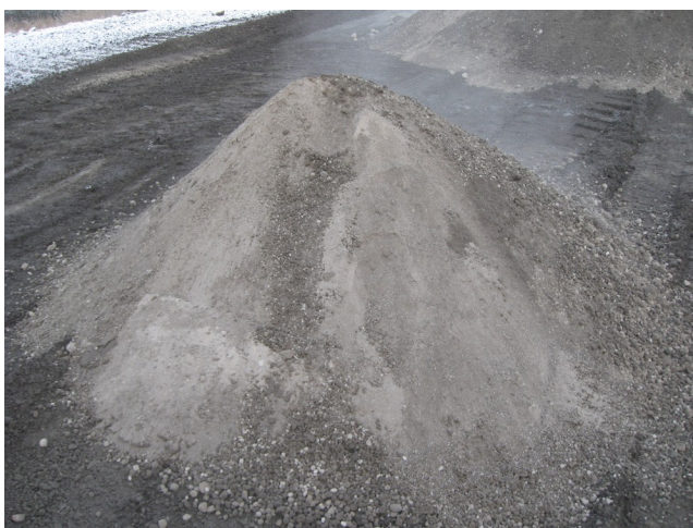
Abb. 4+5: Auf beiden Bildern ist zu sehen, wie unterschiedlich durchfeuchtet und damit staubend der abgeschüttete Filterstaub ist (feuchter Filterstaub: dunkle Farbe, trockener Filterstaub: hell).
