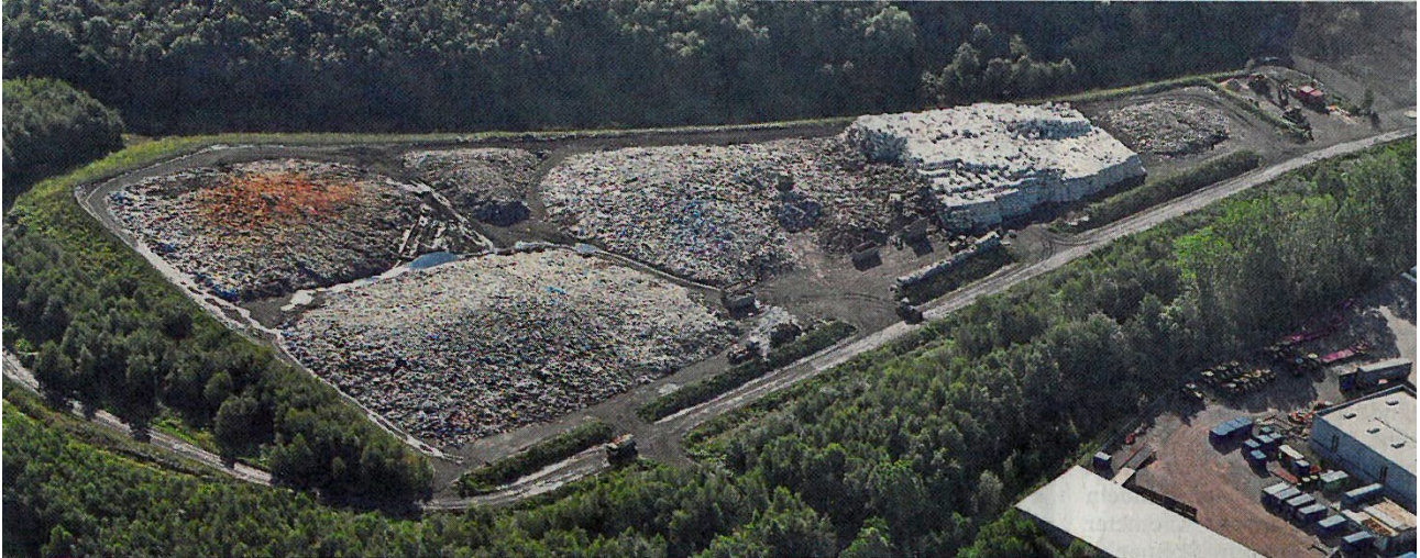
Abb.2 zeigt eine neuere Aufnahme vom Zwischenlager. Das Bild (Quelle: TAZ vom 21.09.2015) zeigt fünf aufgeschüttete Mieten und rechts eine Miete mit Müllballen. Auf der Miete links oben sieht man eine bräunliche Verfärbung: Hier hat es gebrannt.
