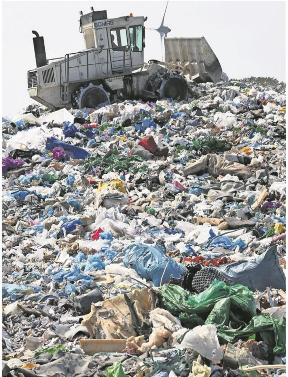
**Ein Kompaktor verdichtet Müll im Zwischenlager. Dort werden Abfälle bis zu zwölf Monate gelagert, die aus betrieblichen Gründen nicht sofort in die Müllverbrennungsanlage können. Die Gutachter gehen davon aus, dass das Zwischenlager bei einer Deponie-Schließung neu gebaut werden müsste.**
